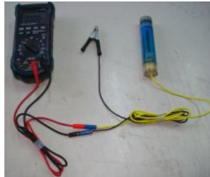
Εικόνα 2. Συνδεσμολογία του συστήματος Concrete Half Cell.
