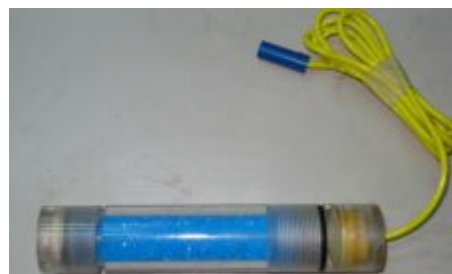
Εικόνα 1. Ηλεκτρόδιο αναφοράς Cu/CuSO 4 συστήματος Concrete Half Cell.
