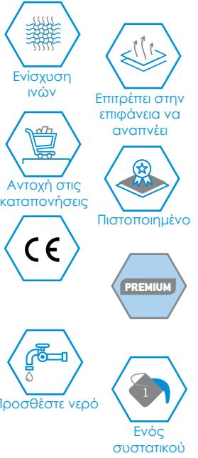
**1-συστατικού, έτοιμο προς χρήση, τσιμεντοειδούς βάσης, ινοπλισμένο, κονίαμα αποκαταστάσεων και επισκευών με θιξοτροπία, τροποποιημένο με ειδικά πολυμερή, που εμπεριέχει υδραυλικά συνθετικά, χαρακτηρίζεται από την εξαιρετή πρόσφυση στο σκυρόδεμα, όπως επίσης, σε πρωτογενείς επιφάνειες τοιχοποιίας. Ιδανικό για εργασίες ανασυγκρότησης αποδιοργανωμένων κατασκευών τοιχοποιίας σε συνδυασμό με την τεχνική ενσωμάτωσης ινοπλέγματος στατικής ένσχυσης από ίνες υάλου.**
