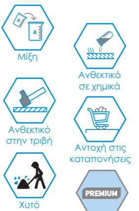
2-συστατικών, χυτή, ημι-ελαστική πολυουρεθανική μαστίχη πλήρωσης αρμών διαστολής ή/και διακοπής, για σφράγιση οριζόντιων αρμών Ανθεκτική σε υδρογονάνθρακες, στην απότριψη και στην γήρανση, με υψηλή αντοχή σε ατμοσφαιρικούς παράγοντες και σε χημικά συστατικά (όπως π.χ. λάδια, ορυκτέλαια, γράσα, ήπιας συγκέντρωσης οξέα και αραιωμένα αλκάλια). Με δυνατότητα παραλαβής κινητικότητας αρμού έως 10%. Για εξωτερική και εσωτερική χρήση, σε δάπεδα/δώματα και αρμούς μεταξύ κτηρίων, οριζόντιους αρμούς
